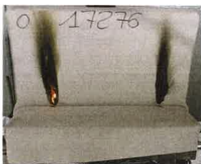
Il secondo innesco sulla provetta campione 2
