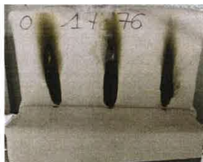
Il terzo innesco sulla provetta campione 2
