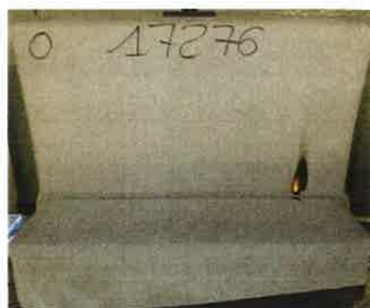
Il primo innesco sulla provetta campione 2
